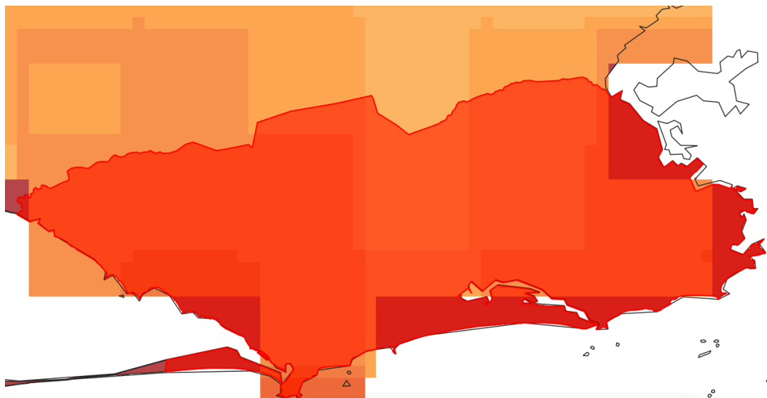
Figura 32. Interseção da camada Raster de irradiação global média do mês de dezembro, segmentada em quadrados de lado 10 x 10 km, com a camada vetorial de Municípios por Distribuidora, tendo como destaque o município do Rio de Janeiro. Fonte: Elaboração própria.
