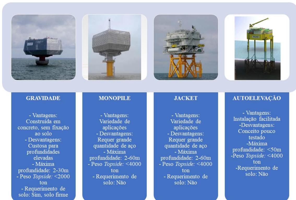
Figura 7: Diagrama com as características dos diferentes tipos de subestação offshore
