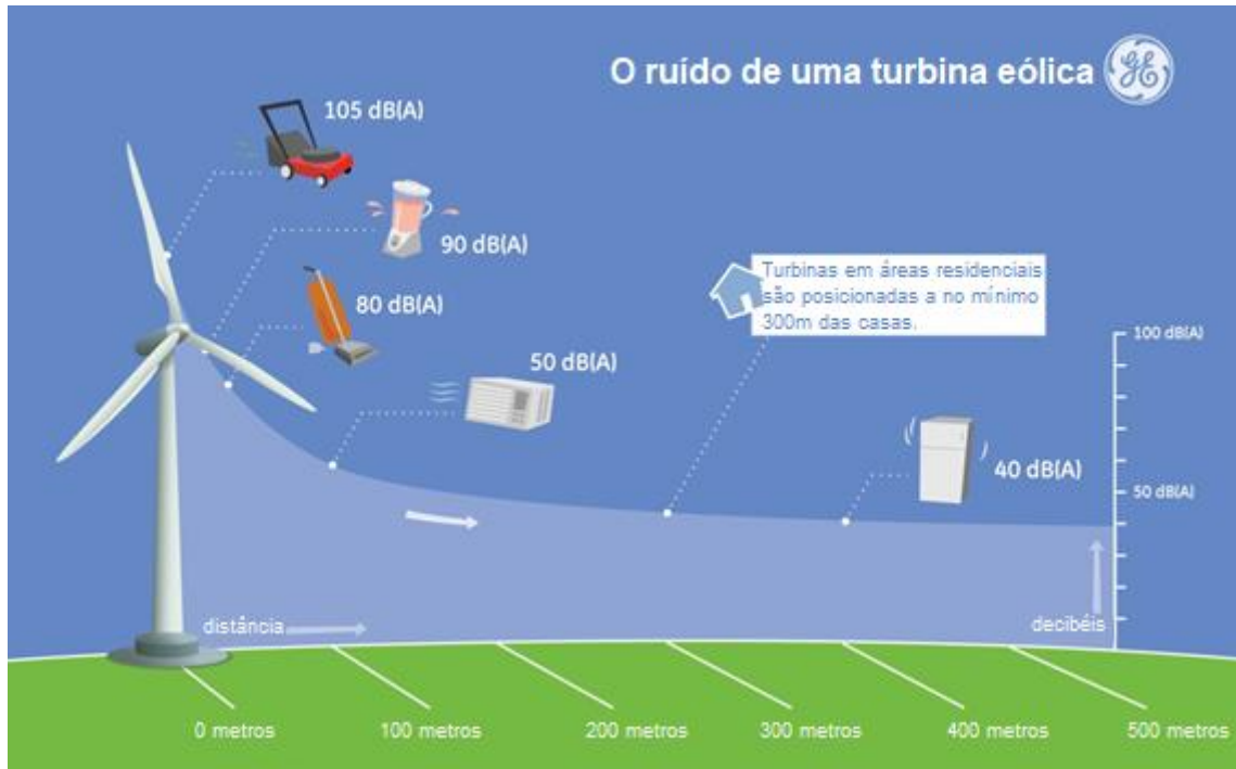
Figura 41: Comparações de ruído com as turbinas eólicas
