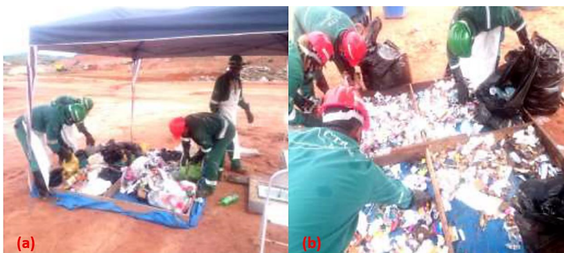
Figura 11. Etapa de homogeneização (a). Etapa de quarteamento (b).
