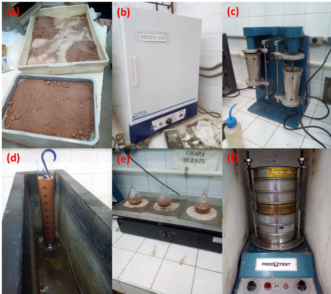
Figura 13. Quarteamento (a). Secagem em estufa a 110 °C (b). Dispensor (c). Ensaio de sedimentação (d). Amostras em picnômetros para determinação da densidade real dos grãos (e). Peneiras empilhadas prontas para o peneiramento fino (f).
