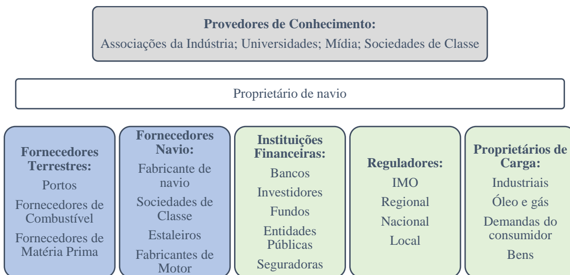
Figura 4: Partes interessadas na adoção de combustíveis alternativos por navios. Em azul os facilitadores, em verde os condutores. Adaptado de DNV GL (2020).
