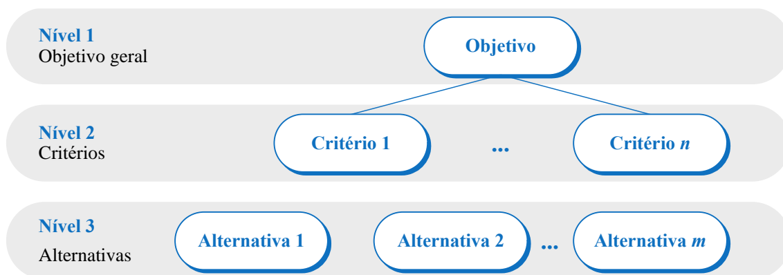
Figura 2.15 – Esquema de uma estrutura hierárquica simples do método AHP Fonte: Elaborado pelo autor, com base em Saaty (1984)
