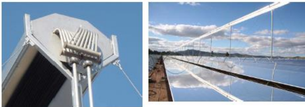
Figura 22 – Refletor Fresnel Fonte: AREVA (2011) apud LODI (2011)
