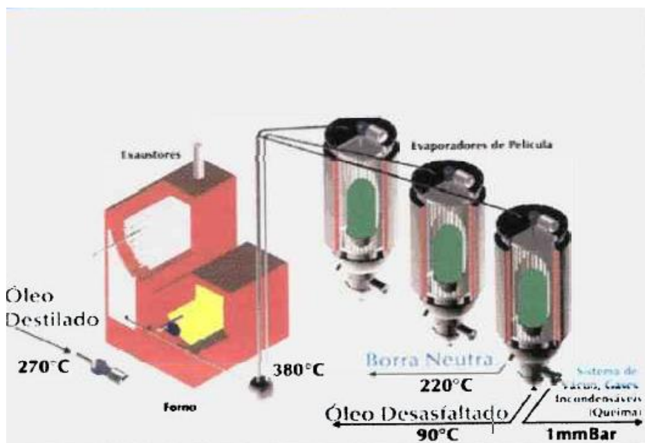
Figura 33: Processo de desasfaltamento
