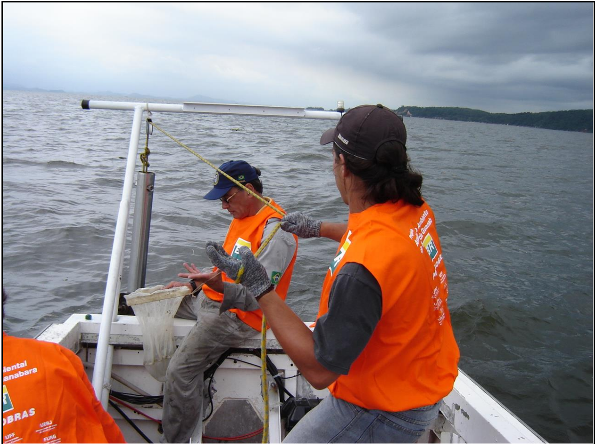
Figura 13. Operação de amostragem da fauna bentônica de substrato não consolidado por meio do amostrador Gravity-corer .
