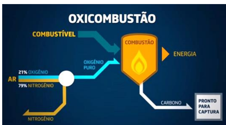
Figura 2.2 – Esquema explicativo da tecnologia de oxi-combustão. Fonte: PETROBRAS, 2015b.
