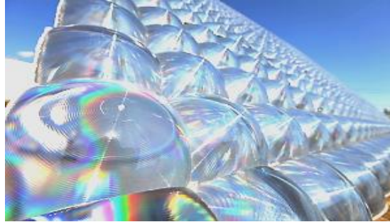
Figura 63: Lentes Fresnel do CFV Daido Stell Fonte: (Daido Stell Co. Ltd., 2014)
