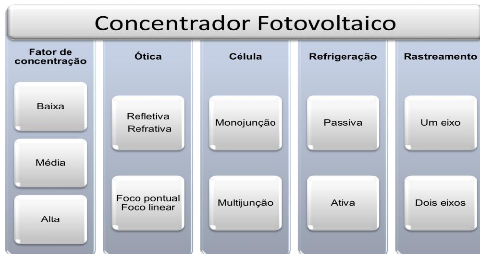
Figura 52: Configurações comuns dos componentes dos concentradores fotovoltaicos Fonte: adaptado de Reis (2013)
