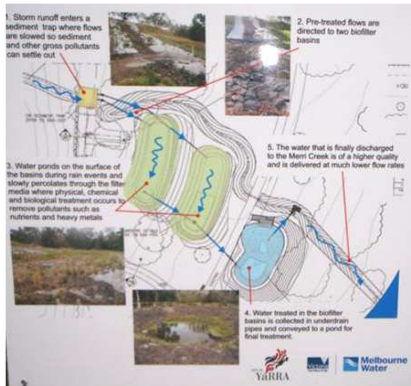
Figura II.A: Sistema de tratamento de águas pluviais do Fairfield Park.
