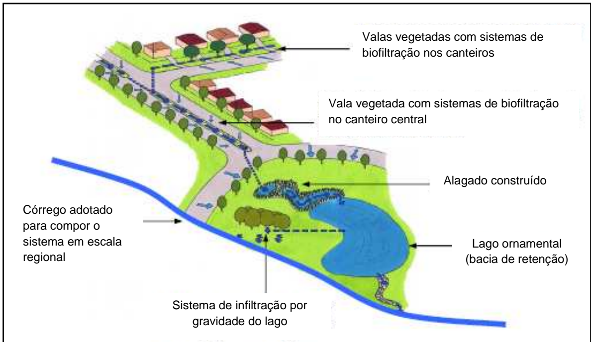
Figura I.A – Desenho Esquemático do projeto WSUD para o Bairro de Lynbrook. Fonte: Lloyd, 2010.
