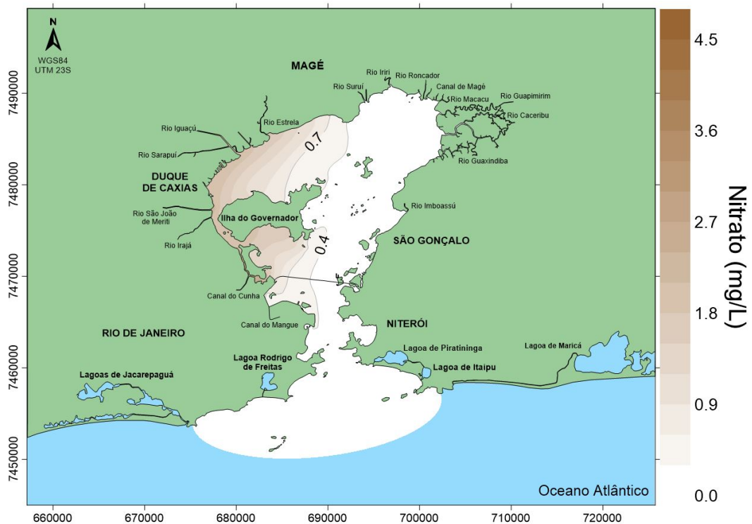
Figura 4.20: Variação estacial dos resultados da concentração de Nitrato (mg/L) obtidos na simulação, com destaque para as isolinhas de 0,4 & 0,7 mg/L
