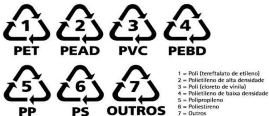
Figura 2 – Simbologia utilizada para identificação de tipos de resinas plásticas.
